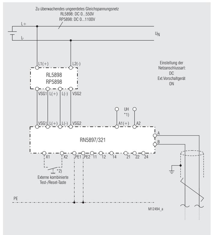
\*1) Hilfsspannung  $U_H$  (A1(+)/A2) kann auch aus dem zu überwachenden Netz entnommen werden. Dabei ist jedoch der Spannungsbereich der Hilfsspannung zu beachten.
