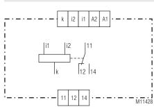
Terminals i1/k: 2 mA ... 11 mA; 0,1 A ... 1,1 A Terminals i2/k: 10 mA ... 110 mA; 1 A ... 10 A
